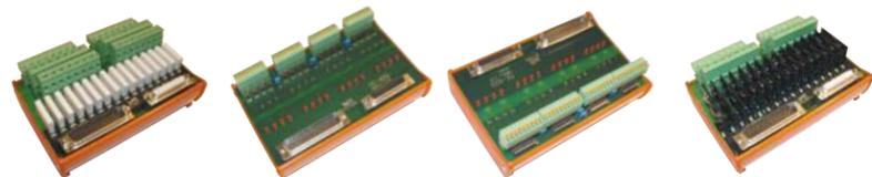
128 TTL-Digital-I/O-Kanäle für PCI-Express, Kanäle erweiterbar mit externen Karten für 128 Opto-Eingänge, Opto-Ausgänge, EM- oder SSR-Relais (elektromechanisch/Halbleiter), Pullup/-down.
