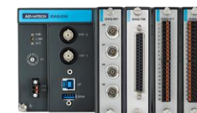
iDAQ-801 + iDAQ-817 + iDAQ-784 + iDAQ-731 iDAQ Module for mixed measurement
